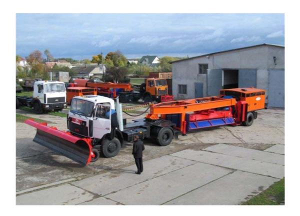
Плужно-щеточная продувочная аэродромная уборочная машина БС-4000ПБА-2И (второй серии) предназначена для круглогодичной уборки снега, льдообразований, изморози, наледи, слякоти, грязи на ИВПП, РД, приангарных площадках и прочих больших площадях аэродрома с искусственным покрытием.
