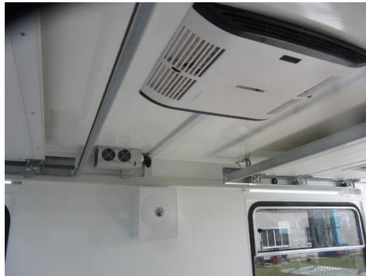
Кузов-фургон оснащен системами кондиционером, вентиляцией
