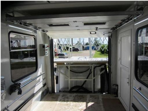
Двери спереди и сзади кузова складные (складываются вверх), передняя дверь - с окном, выходящим на переднюю площадку
