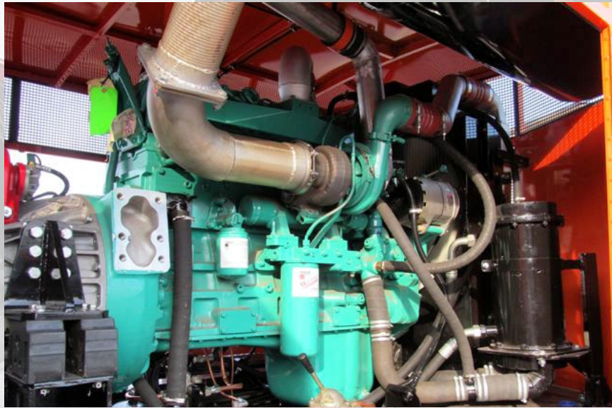
Силовая установка Cummins-420, 420 л.с.
